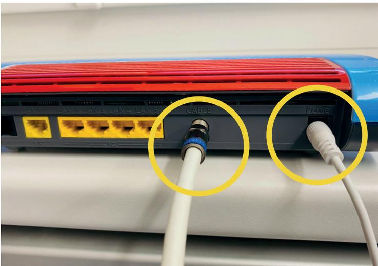
Nun müssen sowohl das Antennenkabel als auch das Netzteil am Modem und an der TV-Dose angeschlossen sein
