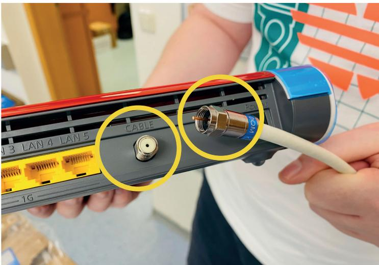
Schrauben Sie das bestehende Antennenkabel an dem Stecker am Modem an.
