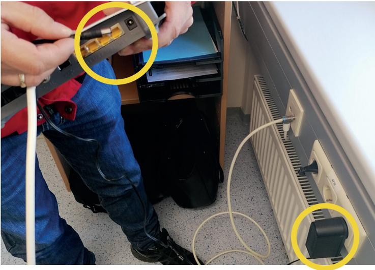
Stecken Sie nun das schwarze Netzteil an das Stromnetz an und schließen Sie das andere Ende beim Modem an.
